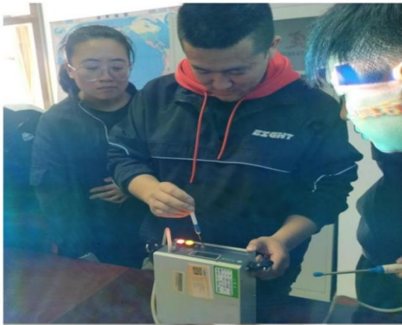
图为外检部使用 ZM-103B 电子皂膜流量计对 DW-18C 智能个体粉尘采样器进行流量校准工作。
